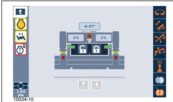
**NOTA:** La superestructura debe girar entre  $179.5^\circ$  y  $-179.5^\circ$  para activar las flechas hacia arriba y abajo del cilindro del contrapeso (8, Figura 5-16).
