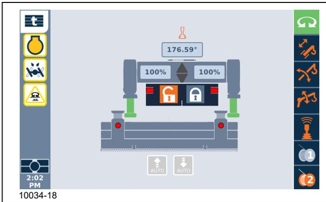
**NOTA:** Las flechas hacia arriba y abajo del cilindro de contrapeso están activas cuando el ángulo de giro de la superestructura está entre  $179.5^\circ$  y  $-179.5^\circ$ .
