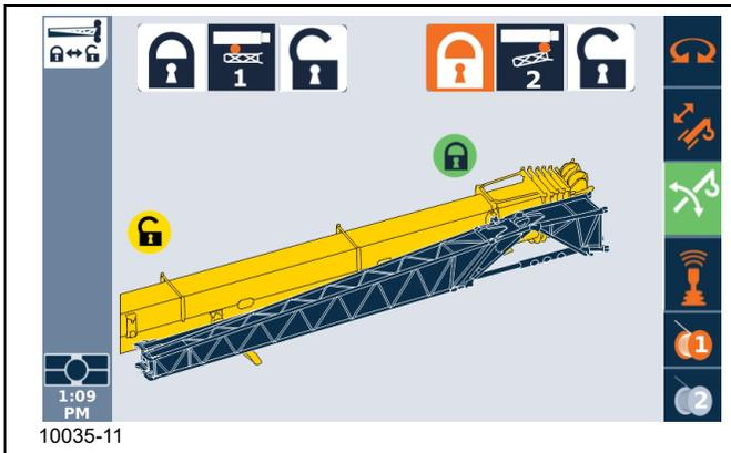
16. Asegúrese de que el ODM muestre que el pasador de montaje delantero (pasador n.º 2) esté extendido. Confirme visualmente que el pasador de montaje delantero esté bien instalado. Bloquee el mango (1, Figura 5-38) con el pasador (2).
